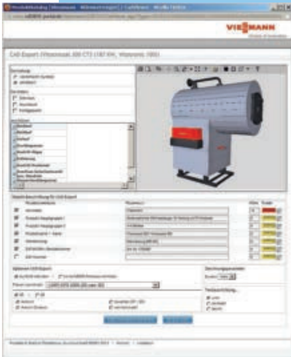
Abb. 6 · Heizkörperauslegung mit einem VDI 3805-Datensatz. (Quelle: Plancal GmbH)
